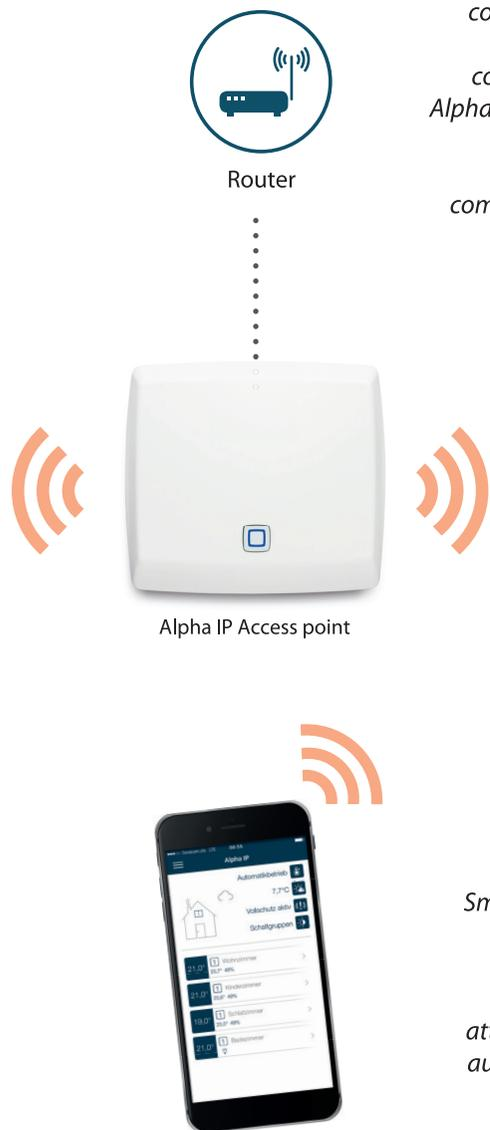
Attraverso un cloud server, L'Alpha IP Access Point collega lo smartphone con tutti i componenti del sistema, consentendo la trasmissione di tutti i comandi di configurazione e di esercizio dell'app Alpha IP. L'installazione richiede solo pochi minuti. In base alle specifiche soluzioni desiderate, successivamente sono installati e configurati i componenti per la termoregolazione e la sicurezza
